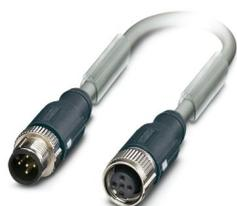
Cavo di sistema bus, CANopen®, DeviceNet™, 5-poli, PUR senza alogenati, grigio-argento RAL 7001, schermata, Maschio diretto M12 SPEEDCON, codifica: A, su Connettore femmina diretto M12 SPEEDCON, codifica: A, lunghezza cavo: 0,3 m, Connettore non schermato
