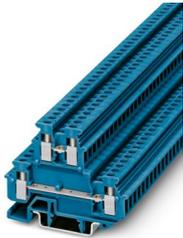
Minimorsetto passante, tensione nominale: 500 V, corrente nominale: 24 A, tipo di connessione: Connessione a vite, 1. e 2. piano, Sezione di dimensionamento: 2,5 mm<sup>2</sup>, sezione: 0,2 mm<sup>2</sup> - 4 mm<sup>2</sup>, tipo di montaggio: NS 15, NS 35/7,5, NS 35/15, colore: blu
