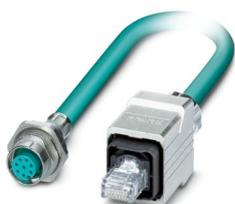
Cavo Ethernet confez., scherm., 4 coppie, AWG 26 compatibile con catene portacavi (19 fili), RAL 5021 (azzurro mare), connett. femm. da incasso M12, montaggio post./a vite con filettatura M16 su connett. maschio RJ45/IP67, Push-Pull custodia in metallo, Line, lungh. 2 m
