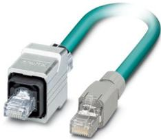
Cavo Ethernet confez., scherm., 4 coppie, AWG 26 compatibile con catene portacavi (19 fili), RAL 5021 (azzurro mare), connett. maschio RJ45/IP67 Push-Pull, custodia in metallo, su connett. maschio RJ45/IP20, Line, lungh. 2 m
