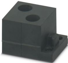
Isolatori passanti, piccoli, numero dei conduttori: 2, esecuzione: Cavo a sezione circolare, intagliato, diametro esterno conduttore: 2x 6 mm ... 7 mm, materiale: NBR, colore: nero, lunghezza: 29,5 mm, larghezza: 19,5 mm, altezza: 17 mm
