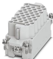
Inserto contatti, numero poli: 40+PE, dimensioni: B16, numero di connessioni per polo: 1, Femmina, Connessione a crimpare, 500 V, 16 A, 0,5 mm<sup>2</sup> ... 4 mm<sup>2</sup>
