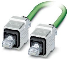
Cavo PROFINET confezionato, CAT5e, schermato, stella quadrupla, AWG 22 flessibile (7 fili), RAL 6018 (giallo-verde), connettore RJ45/IP67, Push-Pull, custodia in metallo, su connettore RJ45/IP67, Push-Pull, custodia in metallo, Line, lunghezza: 10 m
