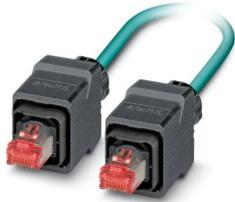
Cavo Ethernet confezionato, CAT5e, schermato, 2 coppie, AWG 26 flessibile (7 fili), RAL 5021 (azzurro mare), connett. maschio RJ45/IP67 Push-Pull custodia in plastica su connett. maschio RJ45/IP67 Push-Pull custodia in plastica, Line, lungh. 2 m
