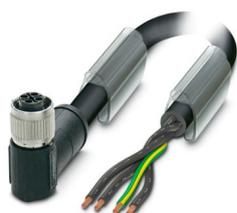
Cavo di alimentazione, 4-poli, PUR senza alogenati, grigio-nero RAL 7021, estremità conduttore libera, su Connettore femmina angolato M12, codifica: S, lunghezza cavo: 10 m, per corrente alternata fino a 12 A/690 V
