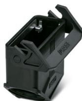
Custodia per giunti B16, con blocc. longitudinale, materiale: PA 6.6-FR, uscite cavi: 1, diritto/laterali, altezza: 81 mm, connessione a vite per cavo: senza, Standard
