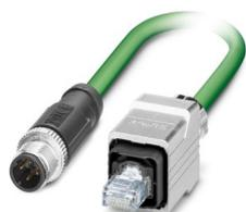
Cavo di rete, PROFINET CAT5 (100 MBit/s), EtherCAT® CAT5 (100 MBit/s), 4-poli, PVC/PVC, verde RAL 6018, schermata (Advanced Shielding Technology), Maschio diritto M12, codifica: D / IP67, su Maschio diritto RJ45 / IP67, lunghezza cavo: 5 m
