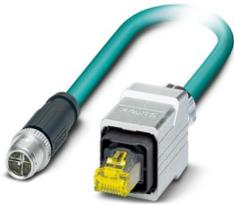
Cavo di rete, Ethernet CAT6<sub>A</sub> (10 Gbit/s), CC-Link IE CAT6<sub>A</sub> (10 Gbit/s), 8-poli, PUR senza alogenati, azzurro mare RAL 5021, schermata (Advanced Shielding Technology), Maschio diritto M12 SPEEDCON, codifica: X / IP67, su Maschio diritto RJ45 Push-Pull / IP67, lunghezza cavo: 10 m
