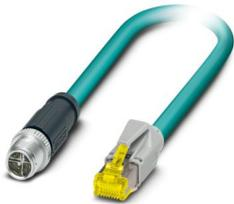
Cavo di rete, Ethernet CAT6<sub>A</sub> (10 Gbit/s), CC-Link IE CAT6<sub>A</sub> (10 Gbit/s), 8-poli, PUR senza alogenati, azzurro mare RAL 5021, schermata (Advanced Shielding Technology), Maschio diritto M12, codifica: X / IP67, su Maschio diritto RJ45 / IP20, lunghezza cavo: 10 m
