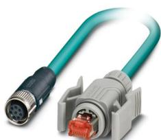
Cavo di rete, Ethernet CAT5 (1 Gbit/s), 8-poli, PUR senza alogenati, azzurro mare RAL 5021, schermata, Maschio diritto RJ45 Bloccaggio a clip / IP67, su Connettore femmina diritto M12 SPEEDCON, codifica: A / IP67, lunghezza cavo: 10 m
