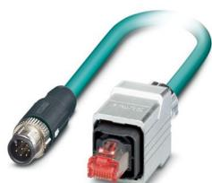
Cavo di rete, Ethernet CAT5 (1 Gbit/s), 8-poli, PUR senza alogenati, azzurro mare RAL 5021, schermata, Maschio diritto M12 SPEEDCON, codifica: A / IP67, su Maschio diritto RJ45 Push-Pull / IP67, lunghezza cavo: 2 m
