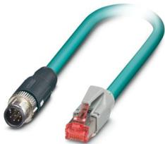
Cavo di rete, Ethernet CAT5 (1 Gbit/s), 8-poli, PUR senza alogenati, azzurro mare RAL 5021, schermata, Maschio diritto M12 SPEEDCON, codifica: A / IP67, su Maschio diritto RJ45 / IP20, lunghezza cavo: 2 m
