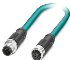
Cavo di rete, Ethernet CAT5 (100 MBit/s), 4-poli, PUR senza alogenati, azzurro mare RAL 5021, schermata (Advanced Shielding Technology), Maschio diritto M12, codifica: D / IP67, su Connettore femmina diritto M12, codifica: D / IP67, lunghezza cavo: 2 m
