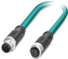
Cavo di rete, Ethernet CAT5 (100 MBit/s), 4-poli, PUR senza alogenati, azzurro mare RAL 5021, schermata (Advanced Shielding Technology), Maschio diritto M12, codifica: D / IP67, su Connettore femmina diritto M12, codifica: D / IP67, lunghezza cavo: 1 m
