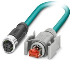
Cavo di rete, Ethernet CAT5 (100 MBit/s), 4-poli, PUR senza alogenati, azzurro mare RAL 5021, schermata, Connettore femmina diritto M12 SPEEDCON, codifica: D / IP67, su Maschio diritto RJ45 Bloccaggio a clip / IP67, lunghezza cavo: 2 m
