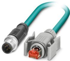
Cavo di rete, Ethernet CAT5 (100 MBit/s), 4-poli, PUR senza alogenati, azzurro mare RAL 5021, schermata (Advanced Shielding Technology), Maschio diretto M12, codifica: D / IP67, su Maschio diretto RJ45 Bloccaggio a clip / IP67, lunghezza cavo: 5 m
