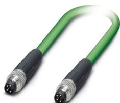
Cavo di rete, Ethernet (100 MBit/s), PROFINET (100 MBit/s), EtherCAT® (100 MBit/s), 4-poli, PVC/PVC, verde RAL 6018, schermata, Maschio diritto M8, codifica: A / IP67, su Maschio diritto M8, codifica: A / IP67, lunghezza cavo: 10 m
