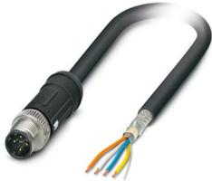
Cavo di rete, PROFINET CAT5 (100 MBit/s), Ethernet CAT5 (100 MBit/s), 4-poli, PE-X senza alogenati, nero RAL 9005, schermata, Maschio diritto M12 SPEEDCON, codifica: D / IP65, su estremità conduttore libera, lunghezza cavo: 5 m, Per le applicazioni ferroviarie
