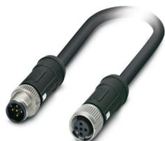
Cavo sensore/attuatore, 5-poli, PE-X senza alogenati, nero, schermata, Maschio diritto M12 SPEEDCON, codifica: A, su Connettore femmina diritto M12 SPEEDCON, codifica: A, lunghezza cavo: 5 m, Per le applicazioni ferroviarie
