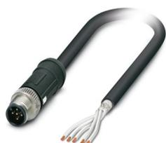
Cavo sensore/attuatore, 5-poli, PE-X senza alogenati, nero, schermata, Maschio diritto M12 SPEEDCON, codifica: A, su estremità conduttore libera, lunghezza cavo: 2 m, Per le applicazioni ferroviarie
