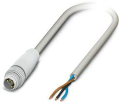
Cavo sensore/attuatore, 3-poli, PP-EPDM senza alogenati, grigio RAL 7035, Maschio diritto M8, codifica: A, su estremità conduttore libera, lunghezza cavo: 3 m, Hygienic Design, con ghiera in plastica
