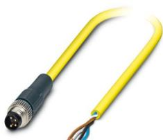
Cavo sensore/attuatore, 4-poli, PVC, giallo, Maschio diritto M8, su estremità conduttore libera, lunghezza cavo: 5 m
