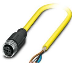
Cavo sensore/attuatore, 4-poli, PVC, giallo, schermata, estremità conduttore libera, su Connettore femmina diritto M12, codifica: A, lunghezza cavo: 5 m
