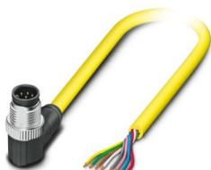
Cavo sensore/attuatore, 8-poli, PVC, giallo, Maschio angolato M12, codifica: A, su estremità conduttore libera, lunghezza cavo: 5 m
