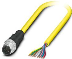
Cavo sensore/attuatore, 8-poli, PVC, giallo, Maschio diritto M12, codifica: A, su estremità conduttore libera, lunghezza cavo: 5 m
