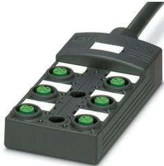
Scatola di distribuzione, tipo di connessione: Connettore femmina M12 Plastica, numero degli slot: 6, numero poli: 4, codifica: A, occupazione slot: singolo, segnalazione di stato: sì, npn; connessione linea principale: Attacco fisso 180°, PUR/PVC, lunghezza cavo: 5 m, schermatura: no
