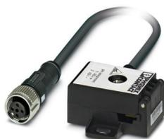
Distributore interfaccia AS con grado di protezione IP67 per 1 cavo piatto, con cavo a sezione circolare PUR da 1,0 m e connettore femmina diritto, codifica A, 2 poli M12 con SPEEDCON
