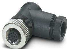
Connettore, Universale, 12-poli, Femmina angolato M12, codifica: A, Attacco a saldare, materiale zigrinato: Pressogetto di zinco, nichelato, connessione a vite per cavo Pg9, diametro esterno conduttore 6 mm ... 8 mm
