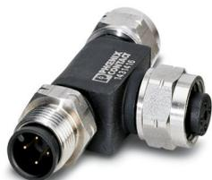
Distributore a T sistema bus, 5-poli, non schermata, Maschio diritto M12, codifica: A, su Connettore femmina diritto M12, codifica: A, PIN 2+4 ponticellati e Connettore femmina diritto M12, codifica: A, PIN 2+4 ponticellati, Collegamento speciale
