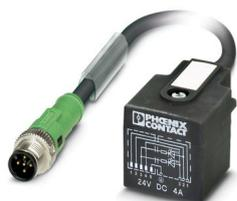
Cavo sensore/attuatore, 5-poli, PUR senza alogenati, grigio-nero RAL 7021, Maschio diritto M12, codifica: A, con 2 LED, su Connettore per valvole AD (pressostato), con 2 LED, Circuito: senza circuito, lunghezza cavo: 1,5 m
