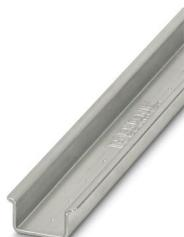
Guida di supporto, non perforata, Variante di imballaggio con 10 pezzi (20 m), a norma EN 60715, materiale: Acciaio, zincato, passivato a strato spesso, Profilo standard 2,3 mm, colore: color argento
