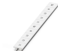
Segnamorsetti, Striscia, bianco, siglato, siglabile con: CMS-P1-PLOTTER, longitudinale: L1, L2, L3, N, PE, L1, L2, L3, N, PE, tipo di montaggio: bloccaggio, per morsetti con spessore: 10,2 mm, Numero dei cartellini singoli: 10, altezza del campo di testo: 10,5 mm, larghezza del campo di testo: 10,15 mm
