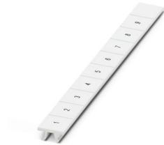
Segnamorsetti, Striscia, bianco, siglato, siglatura longitudinale: numeri progressivi 1 ...9, tipo di montaggio: bloccaggio, per morsetti con spessore: 10,2 mm, Numero dei cartellini singoli: 9, altezza del campo di testo: 10,5 mm, larghezza del campo di testo: 10,15 mm
