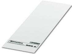
Scheda di siglatura, Scheda, bianco, in bianco, siglabile con: Penna di siglatura, tipo di montaggio: bloccaggio, inserimento a scatto in scanalatura piatta portacartellini, per morsetti con spessore: 6 mm, Numero dei cartellini singoli: 250, altezza del campo di testo: 6 mm, larghezza del campo di testo: 6,1 mm
