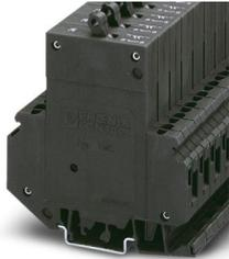
Interruttore di protezione magnetotermico, a 3 poli, semi-ritardato, con 1 contatto in chiusura e 2 contatti in apertura, con piedino universale per il montaggio su NS 32 oppure NS 35
