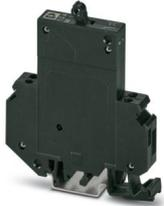
Interruttore di protezione magnetotermico, a 1 polo, semi-ritardato, con 1 contatto in apertura, con piedino universale per il montaggio su NS 32 oppure NS 35
