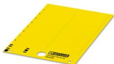
Cartellino ad innesto, Scheda, giallo, in bianco, siglabile con: BLUEMARK ID COLOR, BLUEMARK ID, THERMOMARK PRIME, THERMOMARK CARD 2.0, THERMOMARK CARD, THERMOMARK PRIME 2.0, tipo di montaggio: bloccaggio, Numero dei cartellini singoli: 16, altezza del campo di testo: 15 mm, larghezza del campo di testo: 52,5 mm
