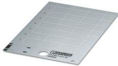
Targhetta in plastica, Scheda, argento, in bianco, siglabile con: BLUEMARK ID COLOR, BLUEMARK ID, THERMOMARK PRIME, THERMOMARK CARD 2.0, THERMOMARK CARD, THERMOMARK PRIME 2.0, tipo di montaggio: colla, Numero dei cartellini singoli: 21, altezza del campo di testo: 18 mm, larghezza del campo di testo: 27 mm
