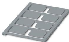
Cartellino ad innesto, Scheda, argento, in bianco, siglabile con: BLUEMARK E.CARD, BLUEMARK ID COLOR, BLUEMARK ID, BLUEMARK CLED, PLOTMARK, CMS-P1-PLOTTER, tipo di montaggio: bloccaggio, Numero dei cartellini singoli: 8, altezza del campo di testo: 18 mm, larghezza del campo di testo: 27 mm
