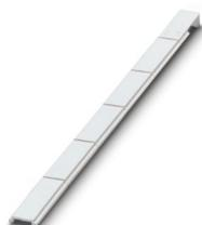
Nastro Zack, ordinabile: a righe, bianco, siglatura custom, tipo di montaggio: inserimento a scatto in scanalatura alta portacartellini, per morsetti con spessore: 18 mm, Numero dei cartellini singoli: 5, altezza del campo di testo: 5 mm, larghezza del campo di testo: 18 mm
