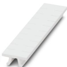
Nastro Zack, ordinabile: a righe, bianco, siglatura custom, tipo di montaggio: inserimento a scatto in scanalatura alta portacartellini, per morsetti con spessore: 5,08 mm, Numero dei cartellini singoli: 10, altezza del campo di testo: 10,5 mm, larghezza del campo di testo: 4,98 mm
