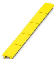
Nastro Zack per contattori, ordinabile: a righe, giallo, siglatura custom, tipo di montaggio: inserimento a scatto in scanalatura piatta portacartellini, per morsetti con spessore: 20 mm, altezza del campo di testo: 8 mm, larghezza del campo di testo: 20 mm
