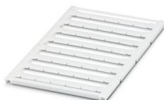
Segnamorsetti, Scheda, bianco, in bianco, siglabile con: BLUEMARK E.CARD, BLUEMARK ID COLOR, BLUEMARK ID, BLUEMARK CLED, PLOTMARK, CMS-P1-PLOTTER, tipo di montaggio: bloccaggio, per morsetti con spessore: 12 mm, Numero dei cartellini singoli: 40, altezza del campo di testo: 5,1 mm, larghezza del campo di testo: 11,45 mm
