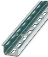
Guida di supporto forata, Variante di imballaggio con 25 pezzi (50 m), simile a norma EN 60715, materiale: Acciaio, zincato, passivato bianco, Profilo standard, colore: bianco
