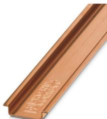
Guida di supporto, non perforata, Variante di imballaggio con 10 pezzi (20 m), a norma EN 60715, materiale: Rame, non rivestito, Profilo standard, colore: rame
