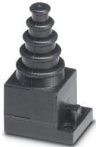
Isolatori passanti, piccoli, numero dei conduttori: 1, esecuzione: Cavo a sezione circolare, chiuso, diametro esterno conduttore: 1x 2 mm ... 11 mm, materiale: NBR, colore: nero, lunghezza: 29,5 mm, larghezza: 19,5 mm, altezza: 17 mm
